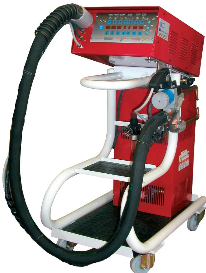
Pinza di saldatura a forbice in fusione di lega di alluminio con cinematismo a leva che permette di sviluppare una notevole forza agli elettrodi anche con bracci lunghi. I bracci e gli elettrodi sono facilmente intercambiabili per configurarli alle diverse condizioni di saldatura.
