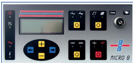
Controllo di saldatura mod. Micro8 Rulli, sincrono a microprocessore a 5 tempi. Provvede alla temporizzazione, sincrona con la frequenza di rete, delle varie fasi del ciclo (accostaggio, saldatura, tempo freddo e mantenimento), ed alla regolazione della corrente di saldatura mediante parzializzazione con scelta della puntatura in modo continuo o in modo impulsivo. Offre di serie il doppio programma.
