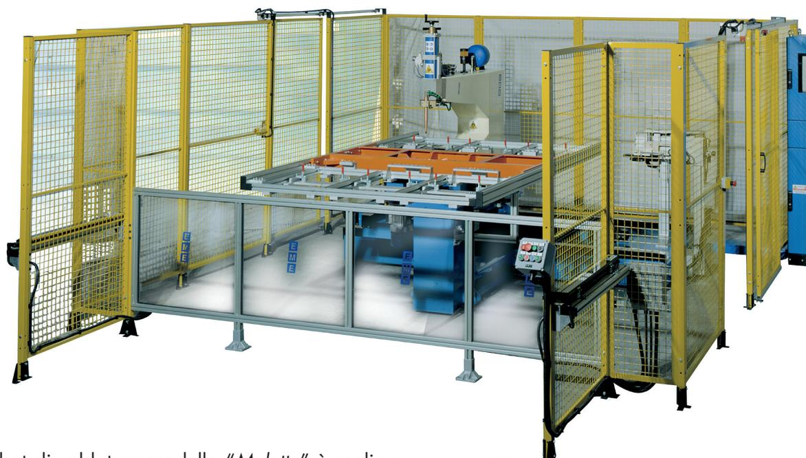
Il robot di saldatura modello "Muletto" è realizzato in lamiera e profilati d'acciaio elettrosaldati, lavorati alla macchina utensile e sottoposti a rigorosi trattamenti di normalizzazione, così da garantire una elevata precisione, unita ad un'ottima rigidità e resistenza alle sollecitazioni meccaniche. La pinza di saldatura in lega leggera, esalta le prestazioni di movimentazione e dinamica di saldatura.
