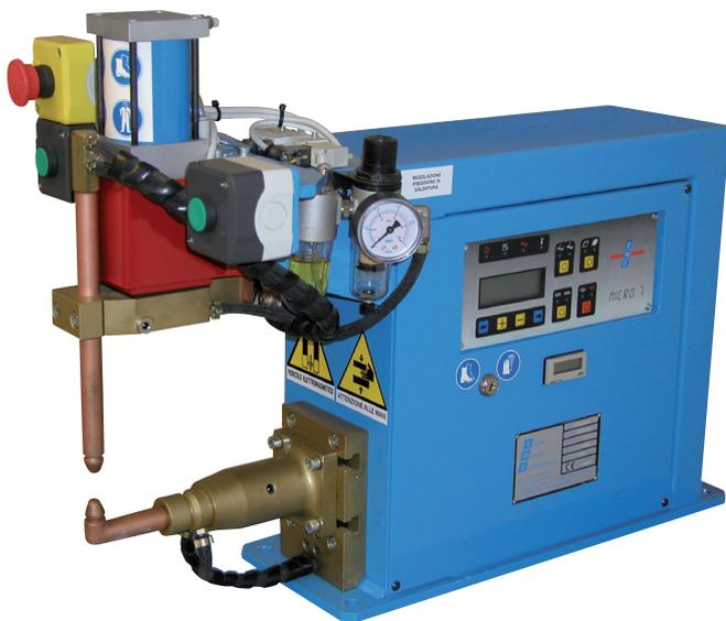
Puntatrice da banco a discesa rettilinea, ad azionamento pneumatico, integralmente raffreddata. Controllo di saldatura digitale MICRO 7. Questo tipo di puntatrice viene utilizzata per saldature su minuterie metalliche, in lega di ottone, rame e argento.
