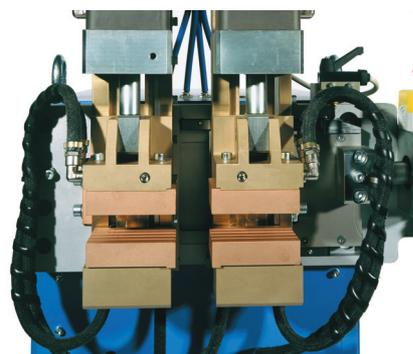
La puntatrice di testa è integralmente raffreddata ad acqua e viene gestita da un controllo di saldatura digitale modello MICRO8 a microprocessore, il quale consente di ottenere buone qualità di saldatura.
